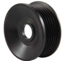
2401-0761 6G Pulley 21mm Belt, 63mm OD
